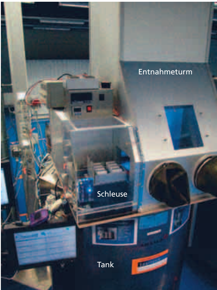
Abbildung 4: Multiplexersystem als Datensynchronisationsstation im Schleusensystem des Entnahmeturms auf einem Kryotank. Die blaue LED zeigt den aktiven Kanal für die Kommunikation mit den Datenträgern in der elektronischen Schublade an.
