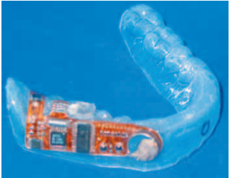
Abbildung 2: Kauschiene zum Nachweis der Machbarkeit.
