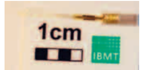
Abbildung 1: Fadenförmige Elektroden (tf-LIFE: thin film longitudinal intrafascicular electrodes). Auf der Führungsstruktur (Polyimidschleife) sind auf jeder Elektrodenseite vier Elektroden platziert, die als Schnittstelle zum Nerven dienen. Weiterhin sind Referenzelektroden zur Ableitung und Masselektroden auf dem breiten außerhalb des Nerven liegenden Elektrodenteils untergebracht. Über eine Dickschichtkeramik wird die Elektrode an weiterführende Kabel angeschlossen.
