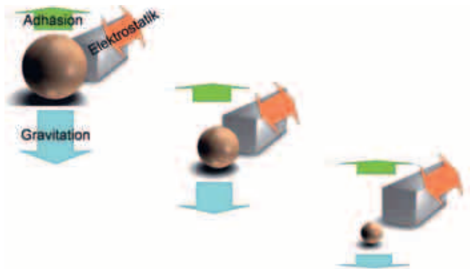
Abbildung 1: Skaleneffekte der beteiligten physikalischen Kräfte Adhäsion, Gravitation und Elektrostatik bei Verringerung der Objektgröße.
